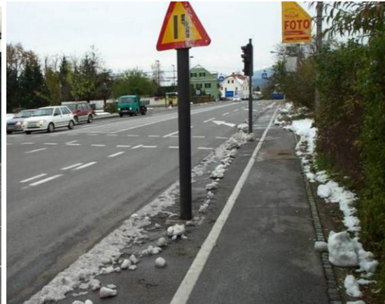
Slika 20 in 21: Na kolesarski stezi je postavljen kiosk (vir: Gregor Steklačič) ali drogovji prometne signalizacije (Vir: kolesarji.org)
