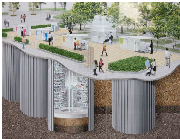
Slika 96: Avtomatska podzemna parkirišča za kolesa - sistem Eco Cycle (vir)
