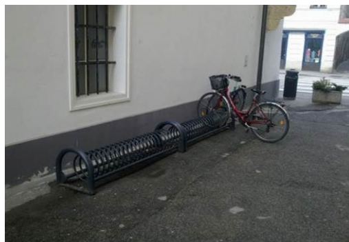
Slika 89: Neprimerna kovinska stojala, ki omogočajo prikllep le enega kolesa (Gregor Steklačič)
